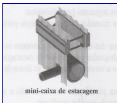
Figura 16 - Mini caixa de estacagem.
