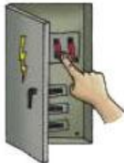
Desligue a energia elétrica
