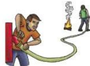
Engate as conexões da mangueira na BI e agulheta e abra a válvula de água
